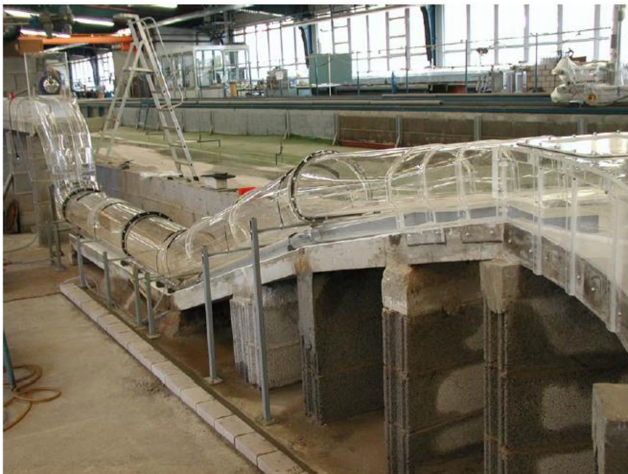
Abb. 7 Modell HS-Nesenbach im Maßstab 1:14
